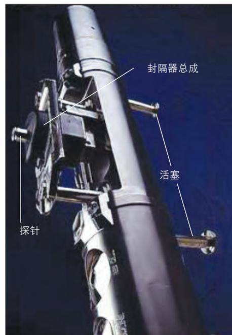
▲ 探针式 WFT。探针式仪器下入指定深度后，仪器从 WFT 的一侧将活塞伸出顶靠至井壁，与此同时封隔器总成被紧紧推靠至待测试的地层。之后，封隔器总成中部的探针深入地层。储层流体通过探针流入到仪器的管线以及取样室，然后将其取至地面。探针周围的封隔器密封阻止井筒流体与储层流体进行混合。
